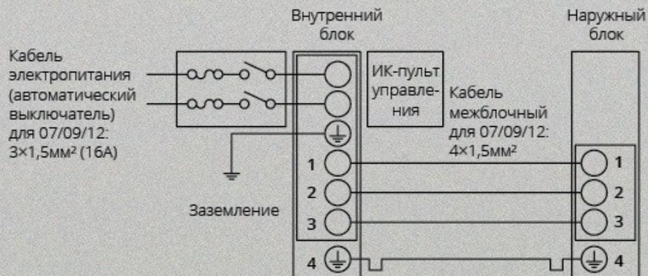
Схема подключения Q inverter (18/24)
